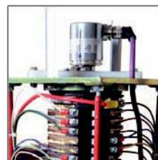
Absolutdrehgeber zur Positionserfassung Absolute encoder for position monitoring
